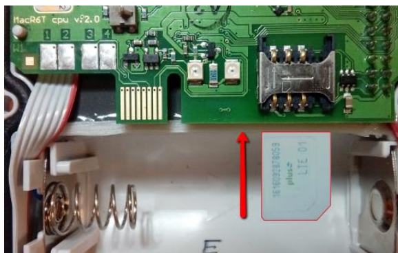
Montaż karty SIM w urządzeniu MacR6-Z0-P
