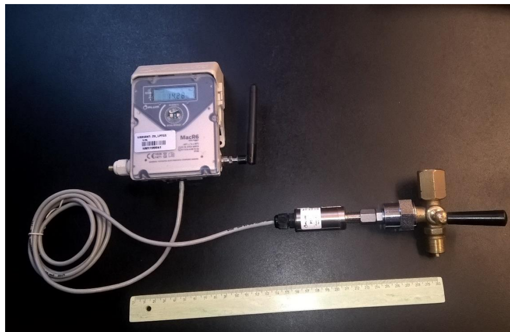
Przykład podłączenia rejestratora z zaworem manometrycznym, trójdrożnym.
