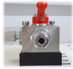
Trzymając małą płytkę za pomocą ręki, dokręć wstępnie zawór trójdrogowy, umieszczając pod nim przekładkę. Dokręć go, aby utrzymać razem wszystkie części, umożliwiając poziomy ruch zaworu.
